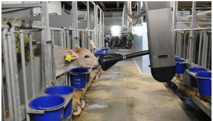
△ Der schienengeführte Tränkeautomat fährt zu den Boxen und trinkt die Kälber dort.
